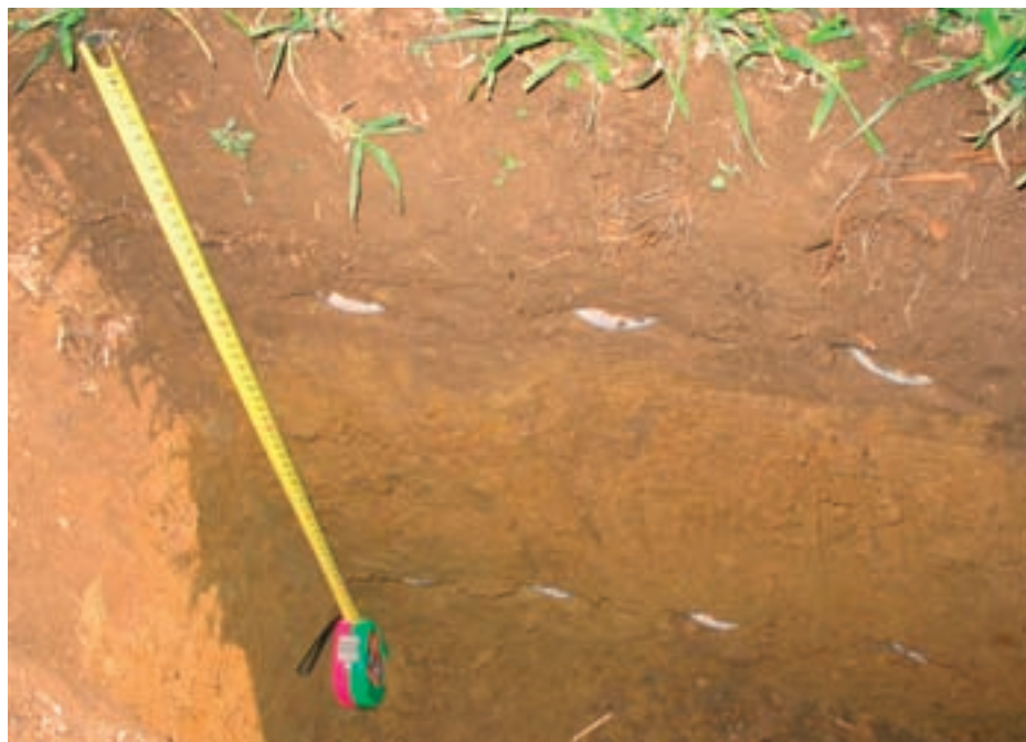
Obr. 3b: Umístění pouzder ve dvou horizontech v sondě
