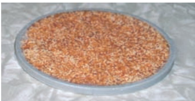
Obr. 2: Detail iontoměničového pouzdra
