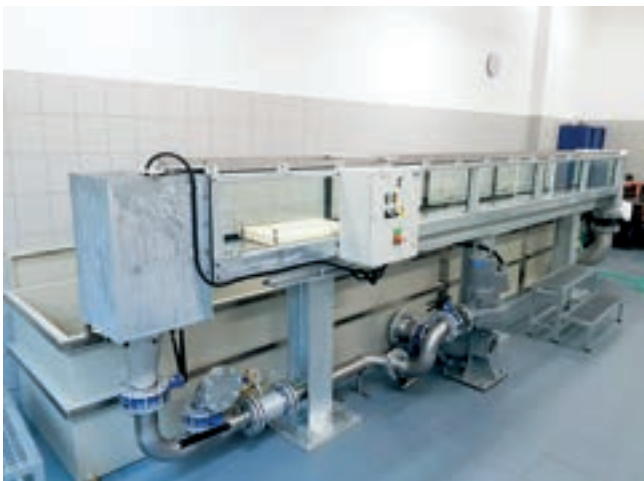
Obr. 1: Poproudí pohled na hydraulický okruh s měrným žlabem
