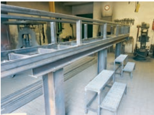
Obr. 3: Konstrukce měrného žlabu před jeho žárovým zinkováním
