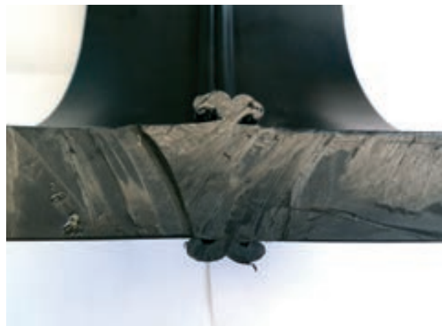
Obr. 1: Skutečný tvar vnitřního svalku ve spoji plastového potrubí zhotoveného metodou svařování na tupo
