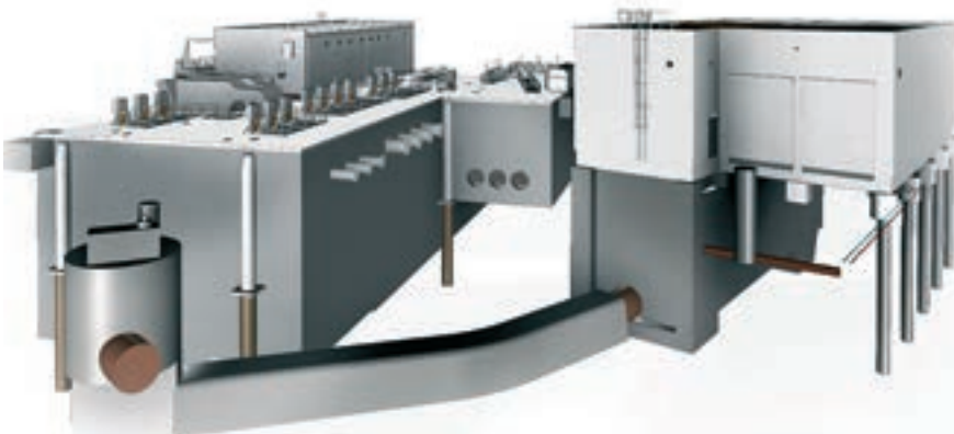
Obr. 5: Celkový pohled na vizualizaci objektů Hlavní čerpací stanice a Hrubého předčištění stoky EF ÚČOV Praha v BIM
