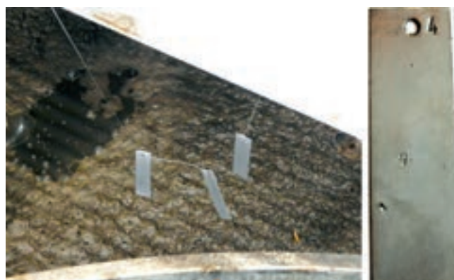
Obr. 3: Korozní kupony korozivzdorné oceli
