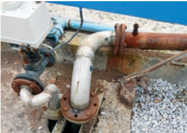
Obr. 14: Bimetalická korozie kontaktu uhlíková – korozivzdorná ocel
