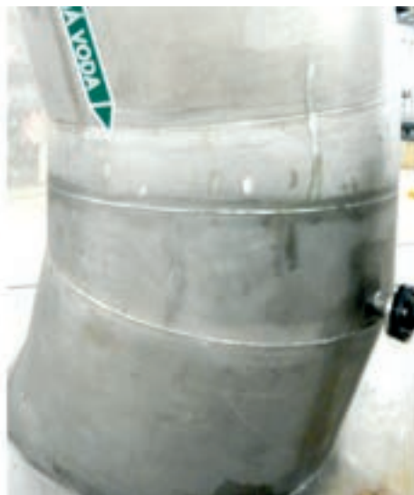
Obr. 16: Lokální korozní napadení pod vrstvou úsad koagulantu
