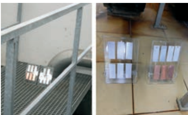
Obr. 2: Umístění korozních kuponů
