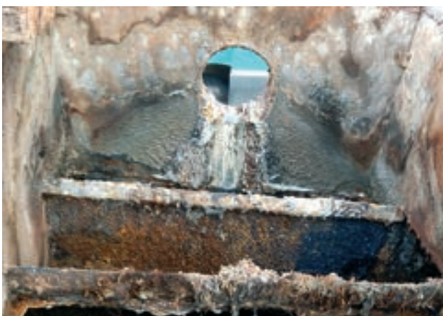
Obr. 11: Vnitřní povrch česlí a detail povrchu korozivzdorné oceli s erozním a důlkovým korozním napadením
