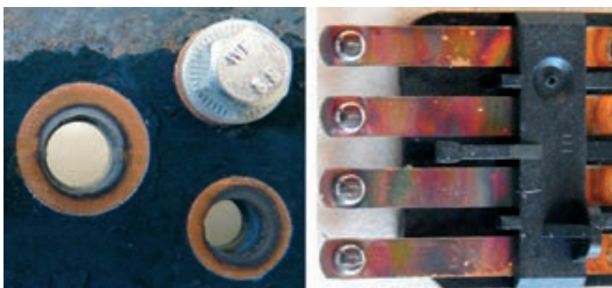
Obr. 7: Příklady korozního napadení elektrotechnických a elektronických zařízení
