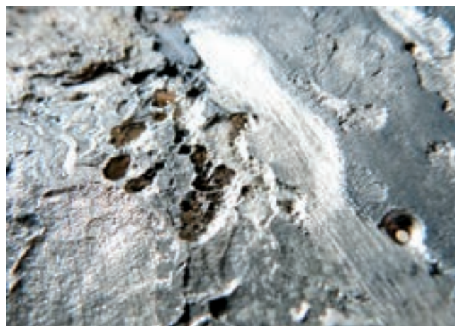
Obr. 11: Vnitřní povrch česlí a detail povrchu korozivzdorné oceli s erozním a důlkovým korozním napadením
