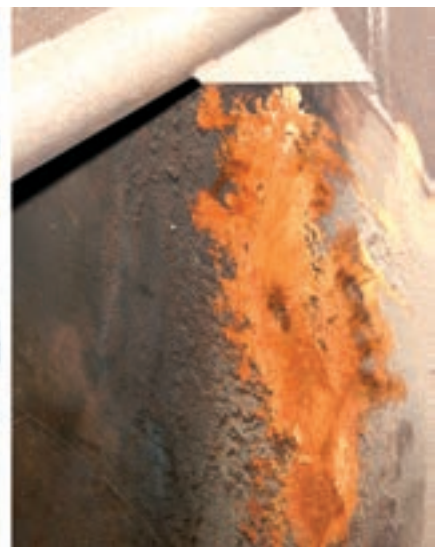
Obr. 16: Lokální korozní napadení pod vrstvou úsad koagulantu
