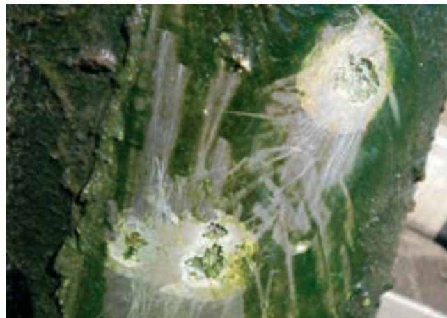
Obr. 10: Stav poškození hliníkové slitiny dosazovací nádrže po čtyřech letech expozice
