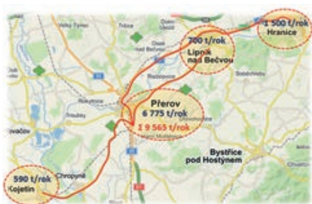
Obr. 1: Produkce a soz odvodněných kalů do kalového centra na ČOV Přerov
