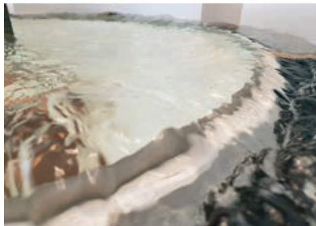
Obr. 5: Pohled na variantu V10 při průtoku 3,0 \text{ m}^3/\text{s}
