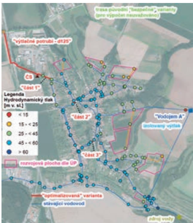
Obr. 3: Minimální hydrodynamické tlaky – výhledový stav
