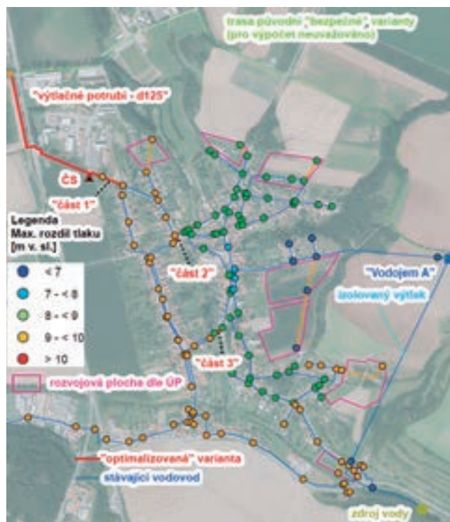
Obr. 4: Rozdíl mezi hydrostatickým a minimálním hydrodynamickým tlakem – výhledový stav
