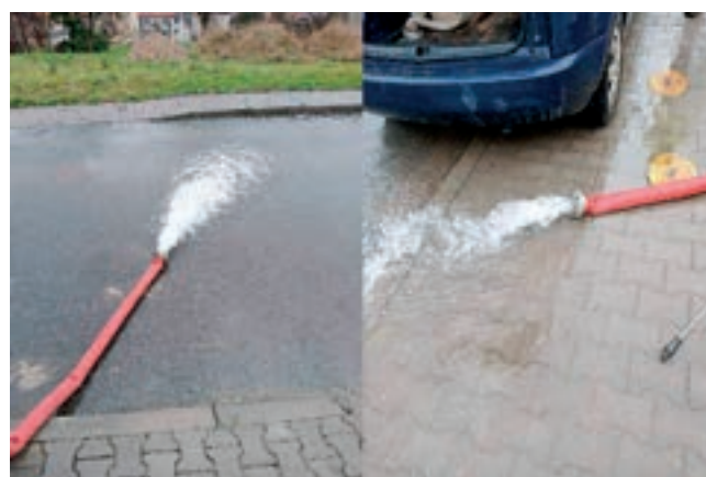
Obr. 2: Ukázka jakostního parametru – zákalu vypouštěné vody během dynamického testu
