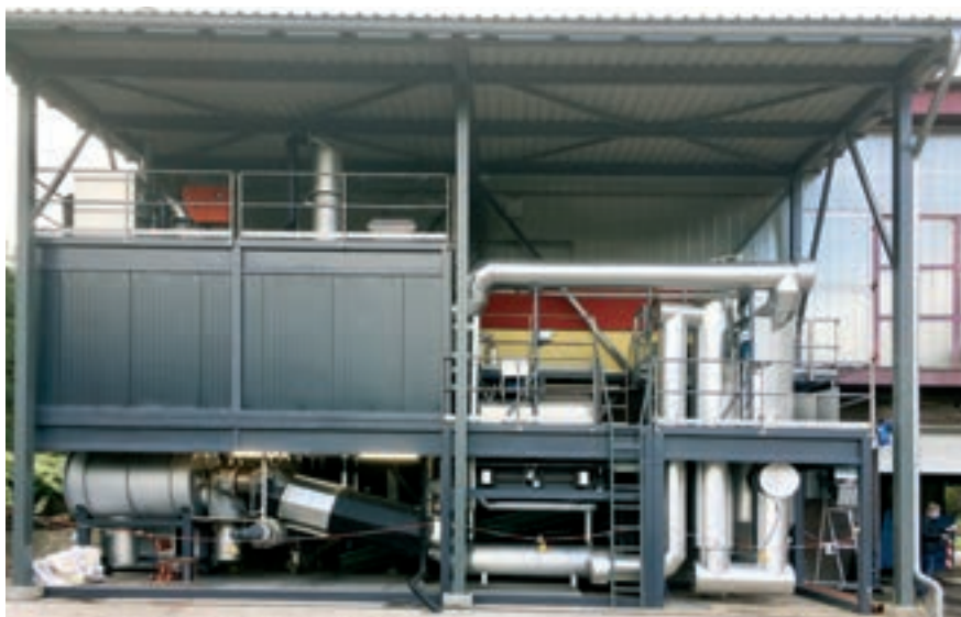
Obr. 4: Pyrolýzér PYREG P500 s čištěním spalin vzniklých spálením primárního pyrolýzního plynu
