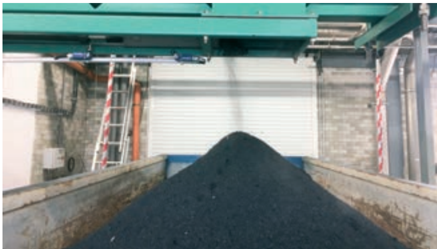
Obr. 2: První provozně vyrobený biochar z čistírenského kalu v ČR vyprodukovaný na ČOV Trutnov
