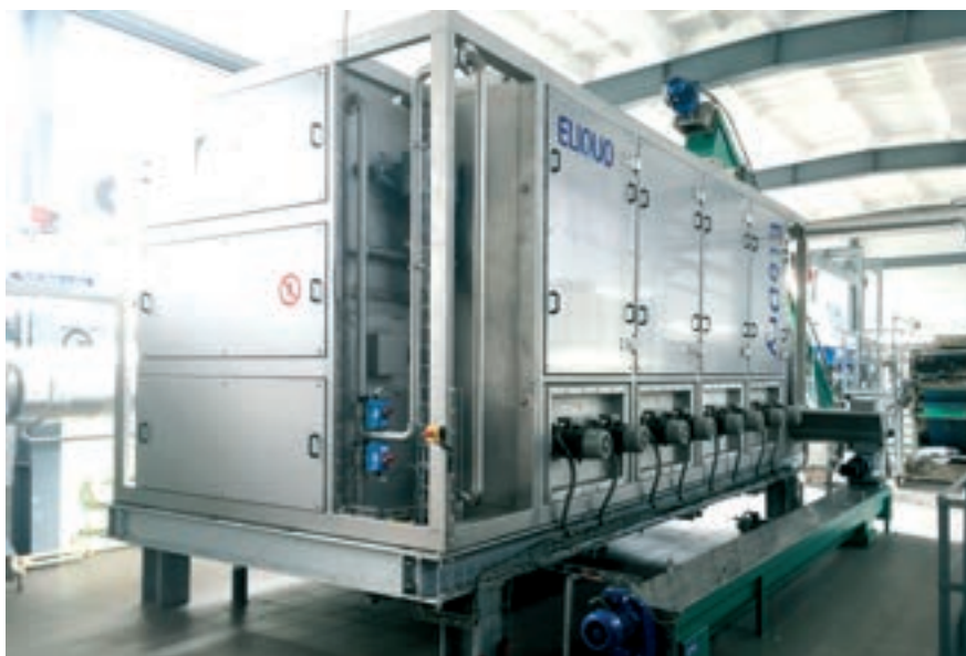
Obr. 3: Nízkoteplotní nekondenzační vzduchem chlazená sušárna ELIQUO EloDry NT16
