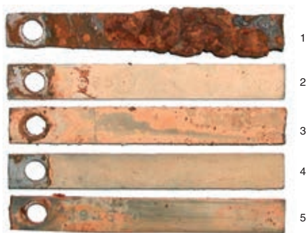
Obr. 1: Porovnání korozních kuponů (1 surová voda, 2 upravená voda, 3, 4 a 5 vodovodní sítě)
