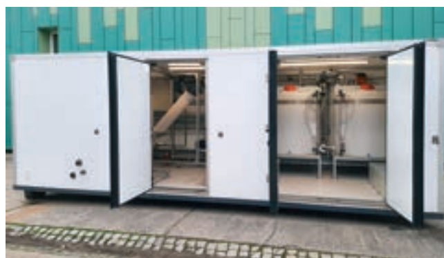
Obr. 5: Mobilní kontejnerová úpravna vody
