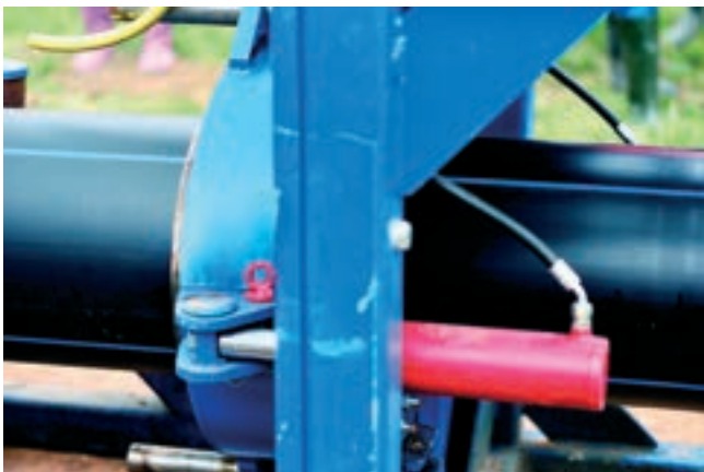
Redukční čelist s 9% redukcí potrubí
