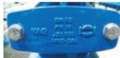
Obr.: Předlitá identifikace na RETOSTOP Zpětné klapce z produkce VAG s. r. o.
