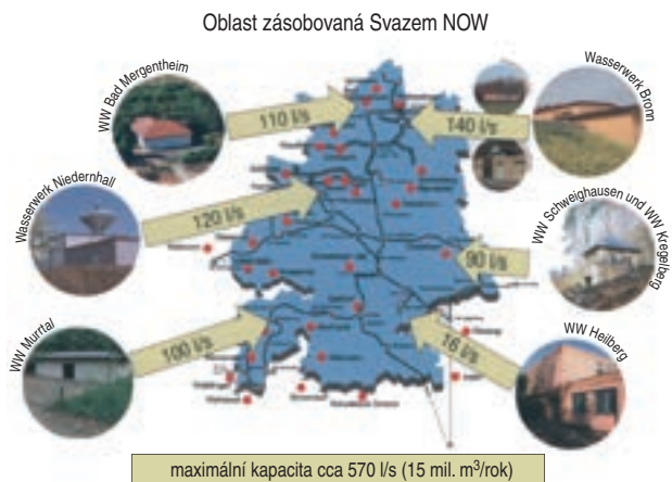
Obr. 4: Zvýšení spolehlivosti zásobování decentralizovanými vodárnami
