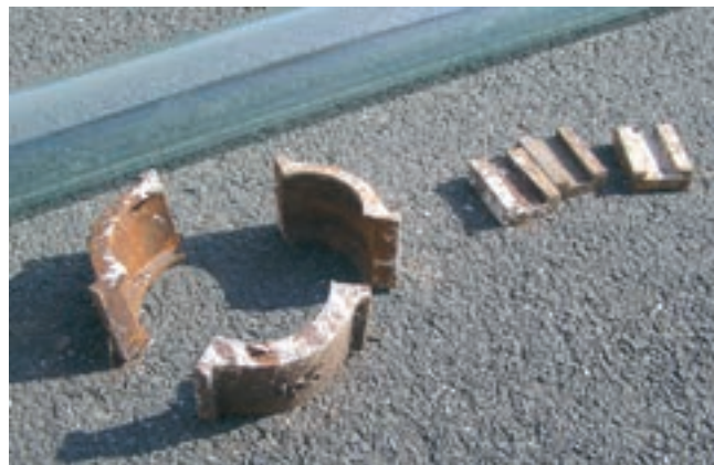
Obr. 10: Litinové segmenty Vymerovy vodotěsnicí spojky
