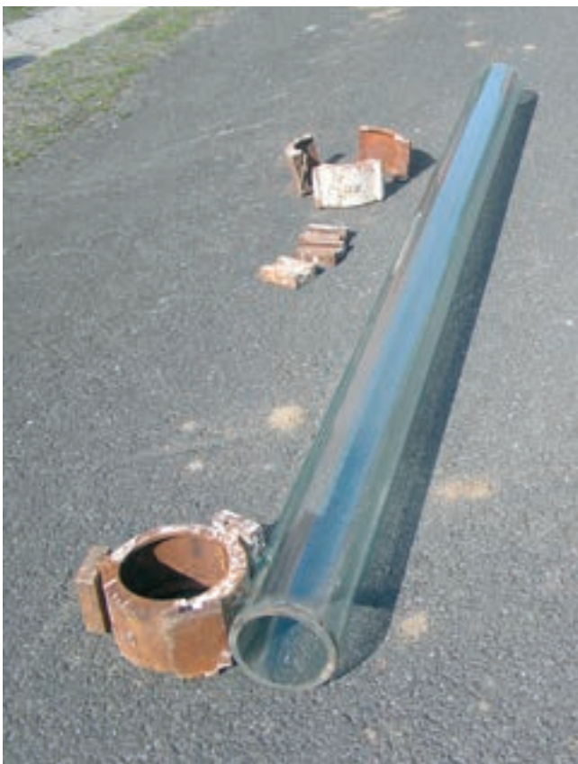
Obr. 9: Skleněné potrubí s Vymerovými vodotěsnicími spojkami
