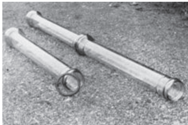
Obr. 3: Skleněné potrubí s hrdlovými spoji [1]
