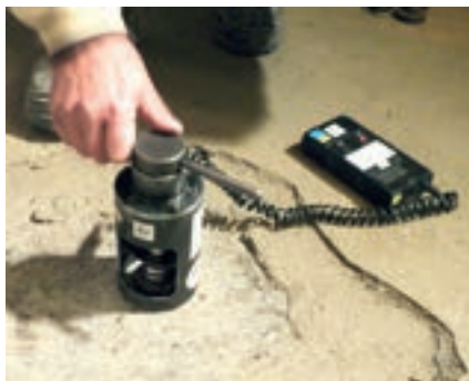
Obr. 7: Provádění odtrhové zkoušky
